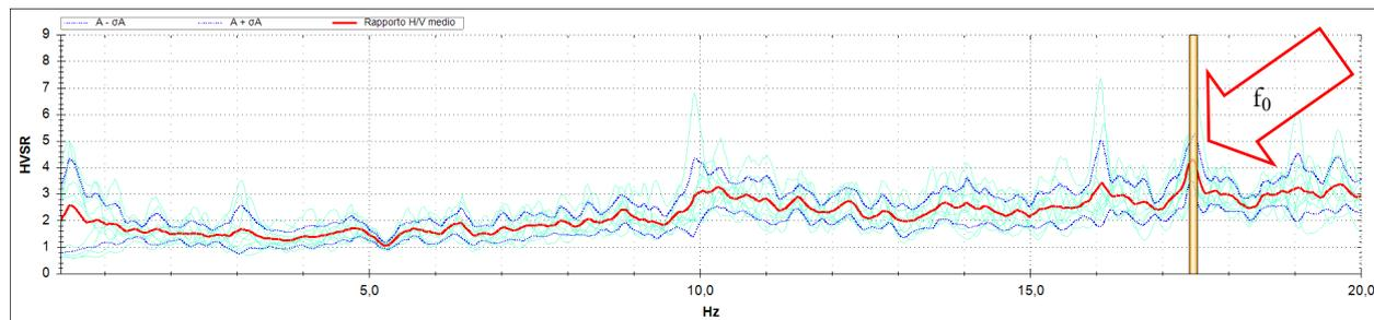
Figura 5 - *Snapshot* Curve HVSR (su scala lineare). Si indica il picco fondamentale  $f_0$  (con  $A_0 \geq 4.2$ ).
