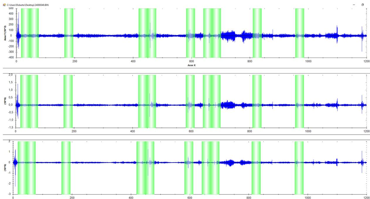
Figura 4 - *Snapshot* Segnale registrato e finestre (n. 10) di elaborazione selezionate.
